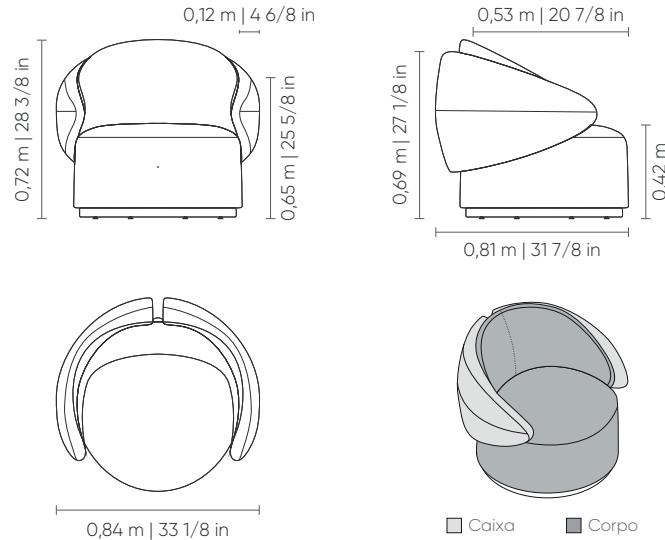
Assento fixo com costura em pesponto simples. Encosto fixo com costura em pesponto duplo. Base em madeira nas opções de acabamento laminado, pintura laca e verniz. Opção de base giratória ou fixa. Detalhe em madeira nas opções de acabamento laminado, pintura laca, verniz e tapeçado.
