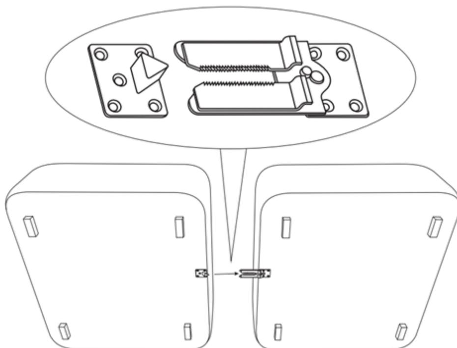
Empurrar um módulo em direção ao outro de maneira que o engate se conecte.
