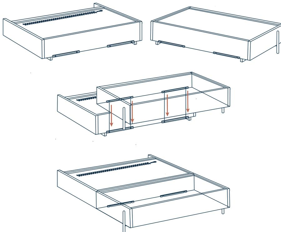
4 - Distribuir toda a capa no estrado, inicialmente colocando a parte do detalhe dos pés. Posteriormente fixando o velcro na parte de cima e por último fixar o velcro na parte de baixo do estrado.
