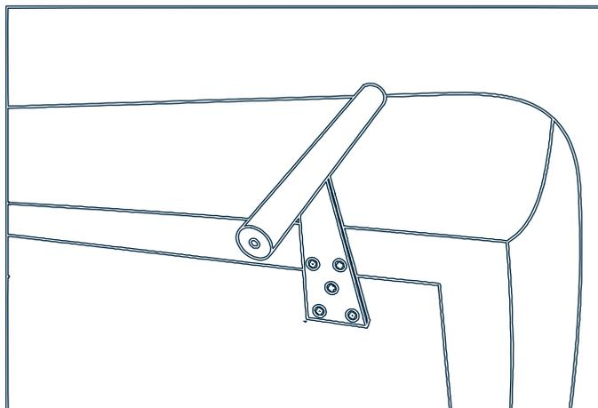
**2** - Identificar lado correto da capa de tecido do estrado (o lado maior do recorte para cima) e posicionar esta, iniciando pela parte das pontas soltas, realizando o encaixe dessas e a fixação do velcro interno.
