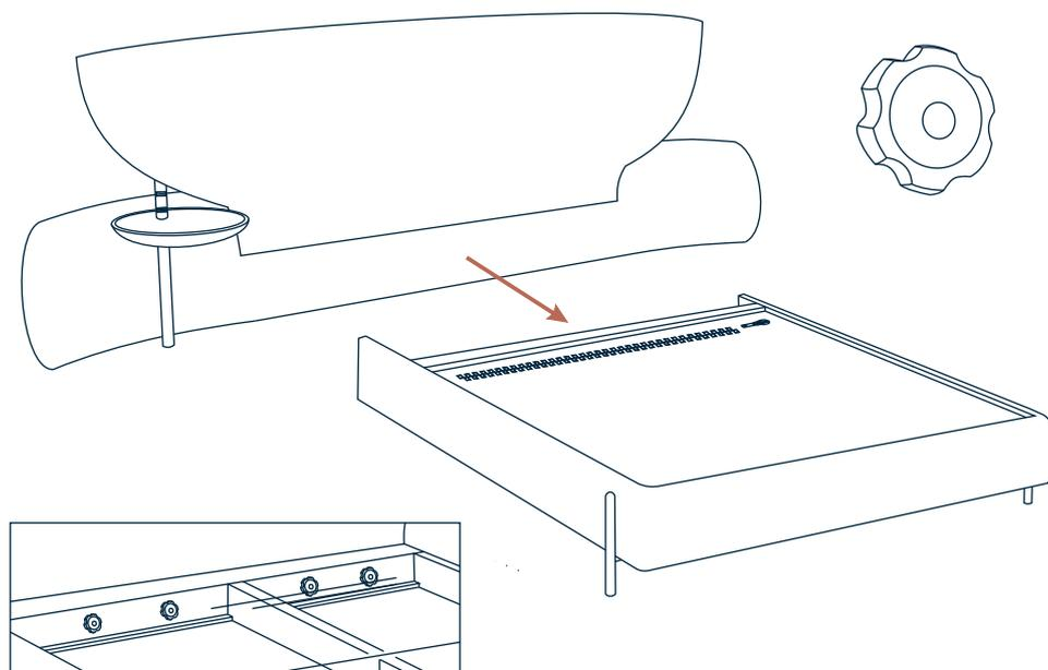
**8** - Encaixar a cabeceira na parte posterior do estrado. Identificar os acessos na parte interna do estrado, para fixação dos manípulos parafusos. Fixar, então, os manípulos nas posições corretas.
