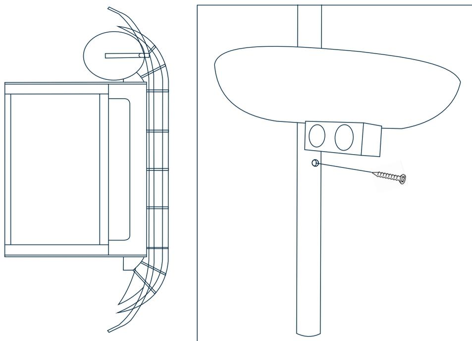
**7** - Encaixar a cabeceira na parte posterior do estrado. Identificar os acessos na parte interna do estrado, para fixação dos manípulos parafusos. Fixar, então, os manípulos nas posições corretas.
