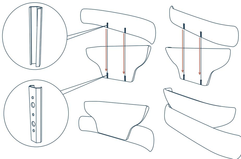
**6** - Caso a cama conte com a opção de mesa, posicionar a mesa na posição indicada, e fixar o parafuso central e então fixar a parte inferior da mesa no encaixe.
